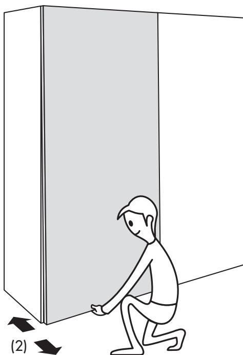
**Scuotere (2) leggermente l'anta nella parte inferiore in questo modo lo stop inferiore si allineerà in modo automatico allo stop superiore.**
